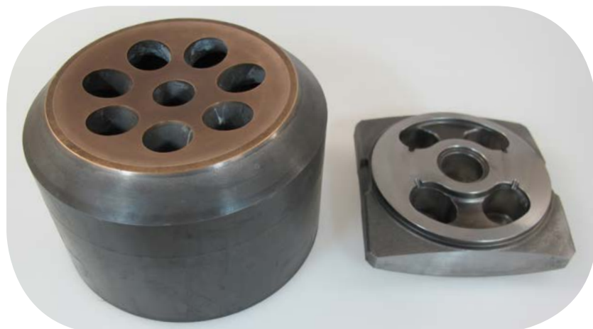
Cuerpo y plato cíclico de bomba de pistón de 125 mm lapeados por encaje
